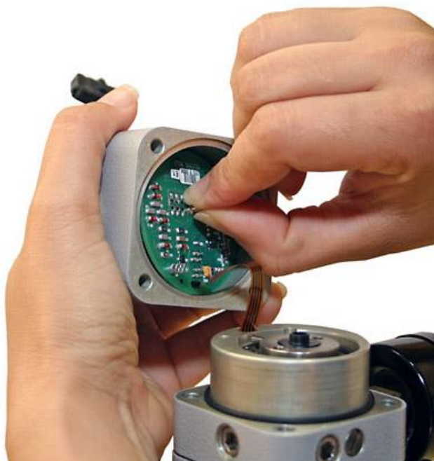
Figura 6.9 – Retirando a placa analógica da tampa de ligação
