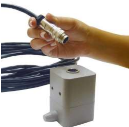
Figura 1.23 – Conectando o cabo ao Sensor de Posição Remoto
