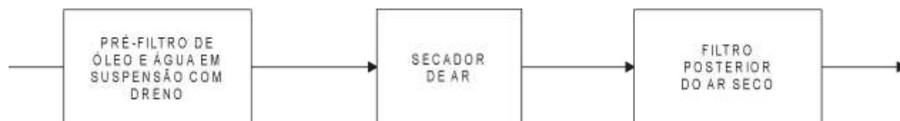
Figura 1.20 - Sistema de Condicionamento da Qualidade do Ar
