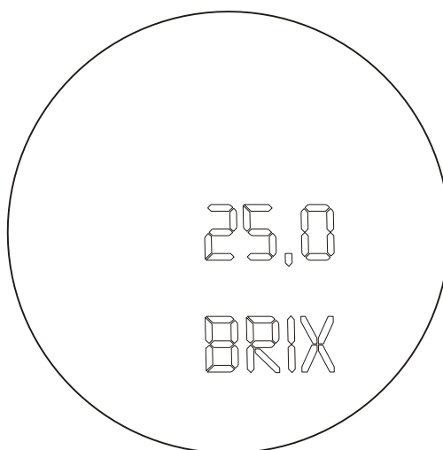
Figura 2.4 - Modo de Monitoração Típico mostrando no indicador a PV, neste caso indicando 25,0 BRIX
