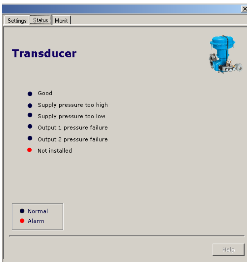
Figura 3.41 - Verificando a Instalação dos Sensores de Pressão do FY303 - ProfibusView
