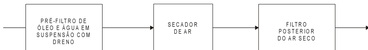
Figura 1.14 - Sistema de Condicionamento da Qualidade do Ar
