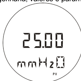
Figura 2.6 – Modo de Monitoração Típica Mostrando a PV, Neste Caso 25,00 mmH 2 O
