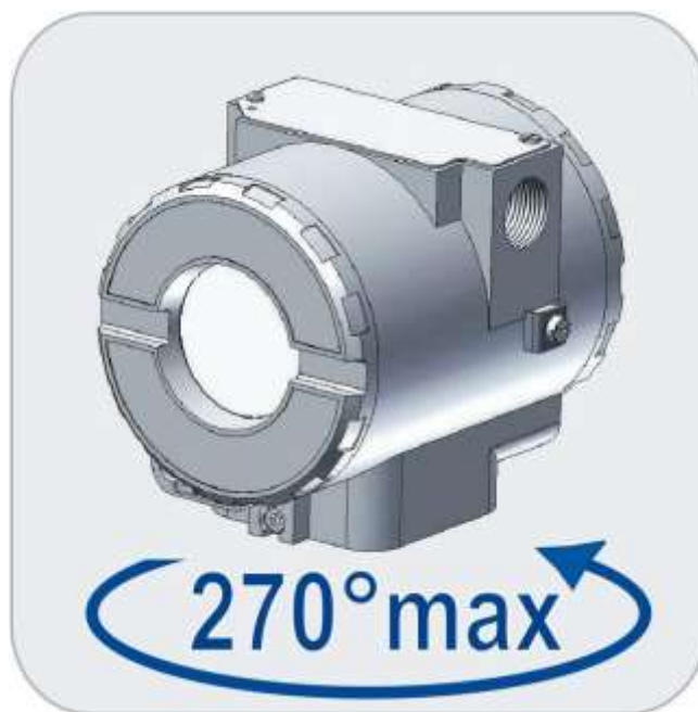
Fig. 4.1 – Rotação do Transmissor
